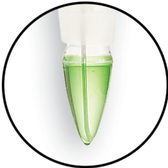
**Unión abierta:** El diseño de unión abierta reduce la obstrucción por los sólidos suspendidos y las proteínas que se
