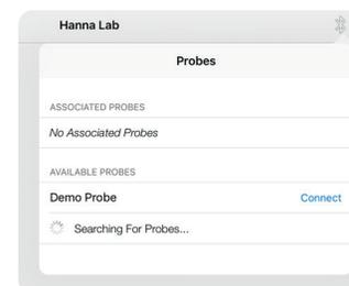
2 Presione el botón de operación en la parte superior del electrodo. Un HALO azul comenzará a titilar cada medio segundo indicando el modo visible. El ID de la sonda aparecerá en la lista de sondas disponibles.
