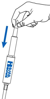
4. Agite el electrodo como lo haría con un termómetro clínico para eliminar cualquier burbuja de aire dentro del bulbo de vidrio. Retire el exceso de gel y el electrodo estará listo para su uso.
