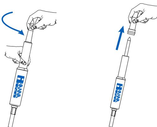
2. Limpie cualquier rastro de suciedad de gel de electrolito con una de las siguientes soluciones de limpieza: HI7061, HI70630, HI70631 o HI70641. Llene el espacio interior con gel de relleno HI9071 para HI9071 aproximadamente  $\frac{1}{3}$  compartimento (si no tiene gel de relleno HI9071, puede usar la solución de almacenamiento HI7082).
