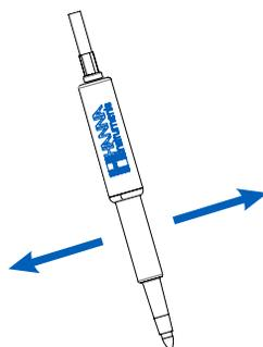
4. Agite el electrodo como lo haría con un termómetro clínico para eliminar cualquier burbuja de aire dentro del bulbo de vidrio. Retire el exceso de gel y el electrodo estará listo para su uso.
