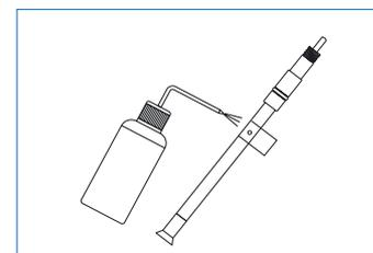
**7-** Llene hasta el tope la solución de relleno, reemplace el oring y tape la abertura del agujero de relleno.
