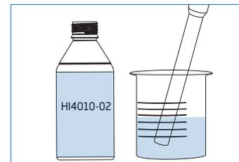
**3-** Si el electrodo va a ser utilizado con frecuencia y necesita estar listo para su utilización, tome medidas para evitar que se evapore la solución de relleno.
