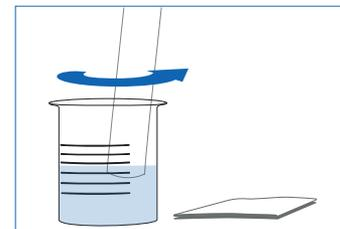
**5-** Para largos períodos de almacenamiento, debe escurrir el electrodo, desarmarlo y lavarlo con agua desionizada.
