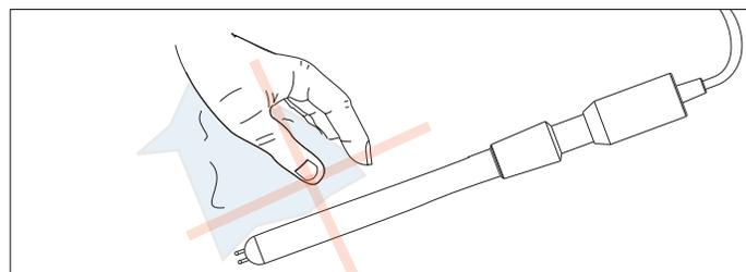
**4•** Si se requiere una limpieza más profunda, sumerja el electrodo durante varias horas en la Solución limpiadora de electrodos de pH de uso general HI7061, luego enjuague con agua y luego con metanol. Deje secar antes de reinstalar.
