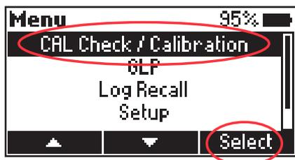
1. Una vez ingrese al menú CAL Check la pantalla mostrará la última revisión realizada. Presione Revisar para iniciar una nueva CAL Check. Pulse la tecla (power) en cualquier momento para cancelar el proceso de validación.
