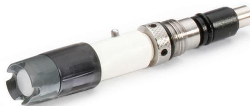
Como recomendación en general para los sensores galvánicos, durante las mediciones en campo, se puede lograr la condición mínima de movimiento agitando manualmente la sonda. No es posible lograr lecturas exactas mientras el líquido está quieto. En procesos de acuicultura se debe evitar tomar las lecturas cercanas o directamente al aireador, para evitar falsos positivos en nuestros resultados.
